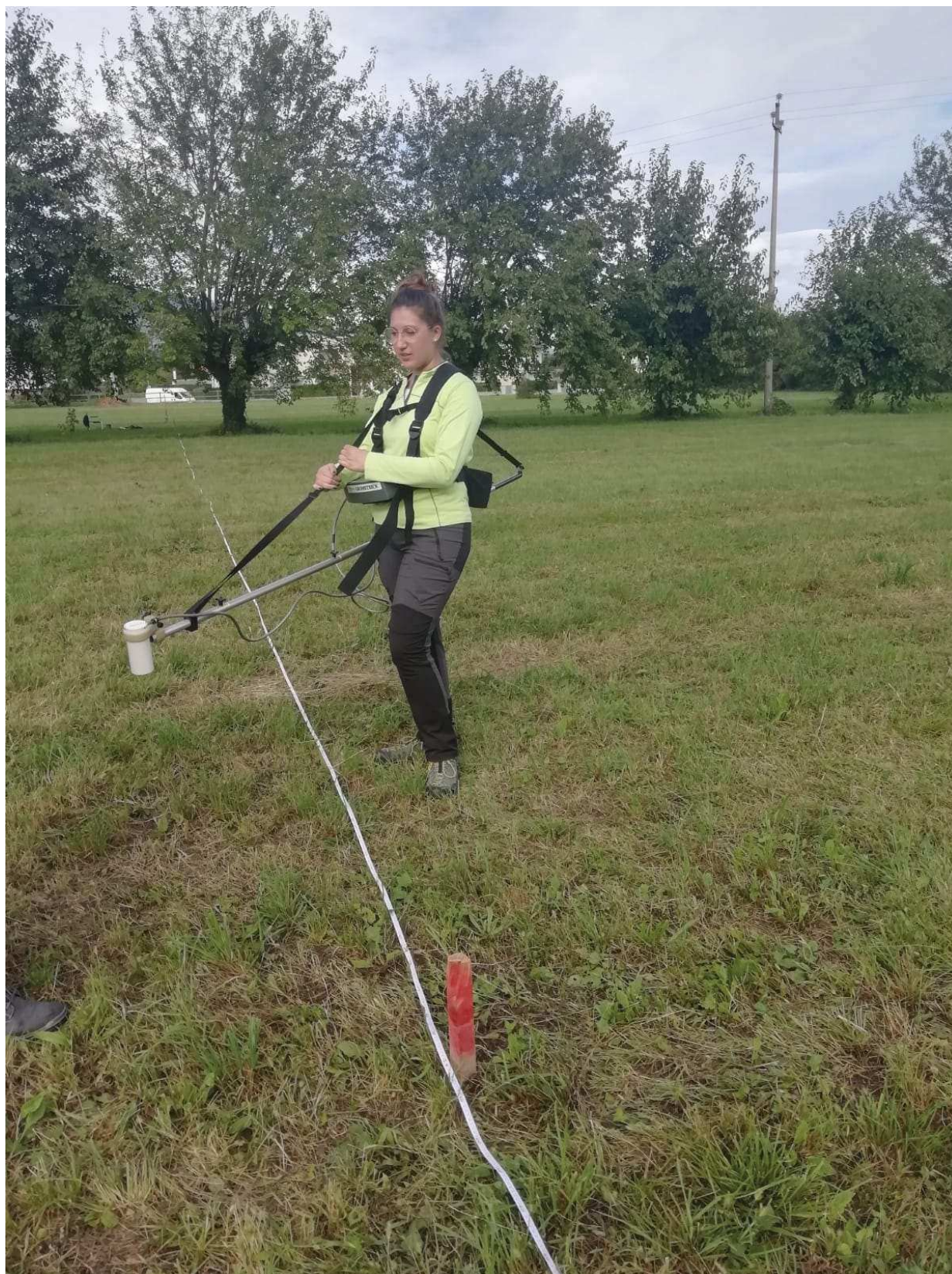
Figura 2 Magnetometro G858 al cesio utilizzato itinerante nell'area
