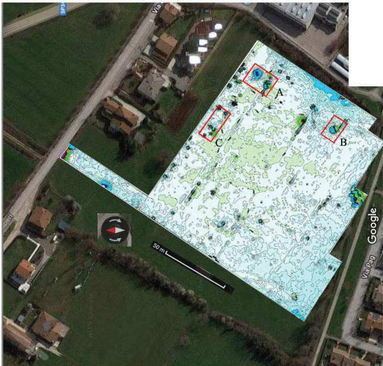
Figura 3 Mappa a curve di livello dell'intensità del campo magnetico. Le anomalie più interessanti sono ubicate all'interno delle tre aree siglate A,B e C.
