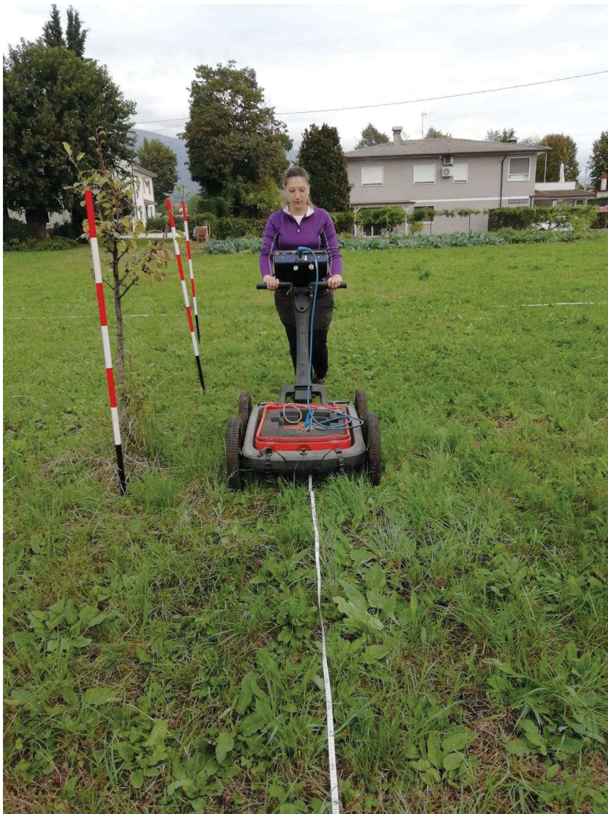
Figura 5 Il georadar SIR 3000 utilizzato nelle aree siglate A, C e D.
