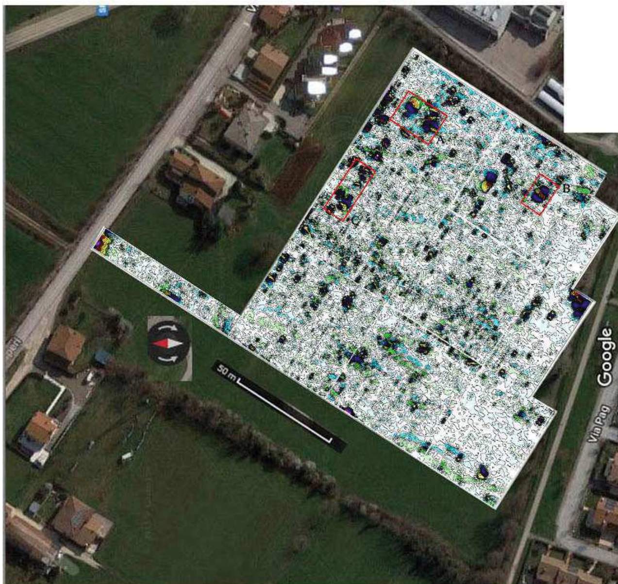
Figura 4 Mappa a curve di livello del gradiente del campo magnetico. All'interno dei rettangoli contrassegnati con le lettere A, B e C sono riconoscibili le stesse anomalie presenti nella mappa dell'intensità del c.m.t. Con la finalità di scoprirne la natura è stata successivamente condotta all'interno delle tre aree una indagine georadar.
